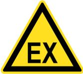
In Räumen, in denen Explosionsgefahr besteht, dürfen keine heißen Teile und nur solche elektrischen Betriebsmittel verwendet werden, die gemäß den Bestimmungen des VDE die erforderliche Explosionsschutzklasse besitzen.
